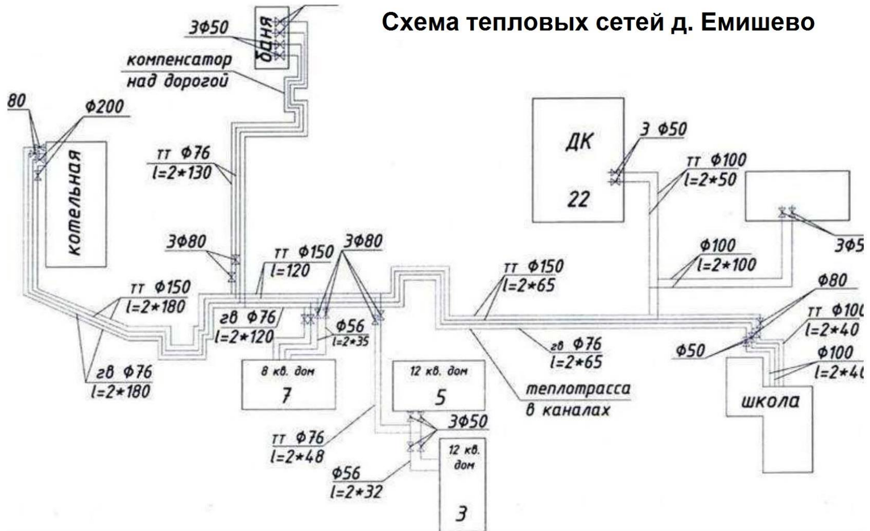
Рисунок 6 Схема тепловых сетей д. Емишево
