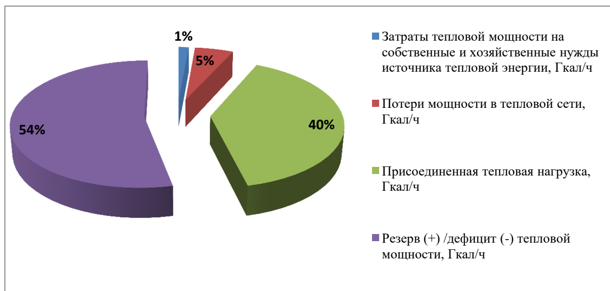
Рисунок 7 Данные о резервах и дефицитах котельной п. Константиновский
