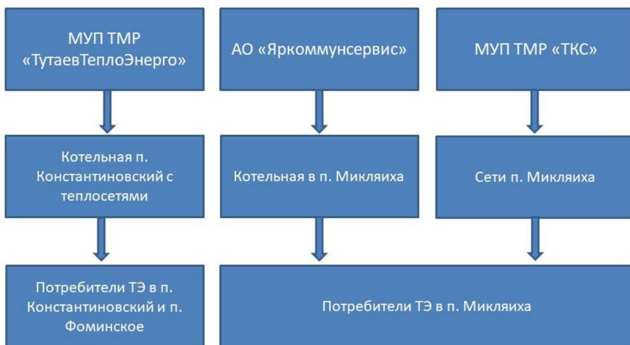
Рисунок 1 Функциональная схема централизованного теплоснабжения
