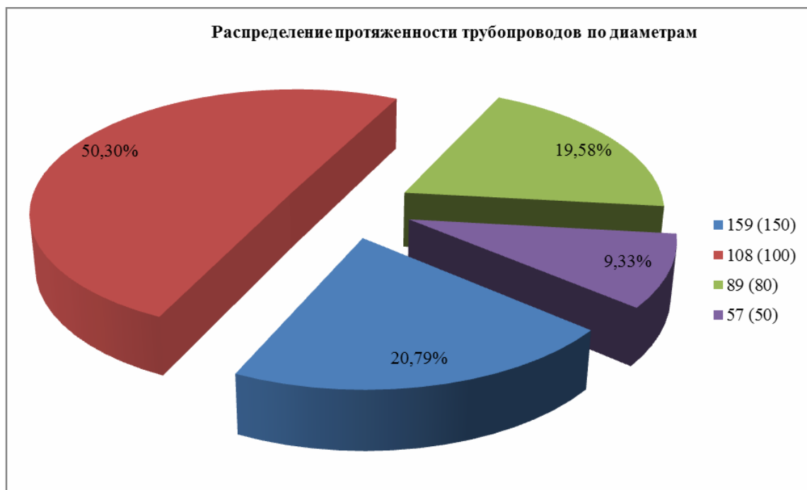
Рисунок 14 Распределение протяженности тепловых сетей по диаметрам от котельной ОПХ
