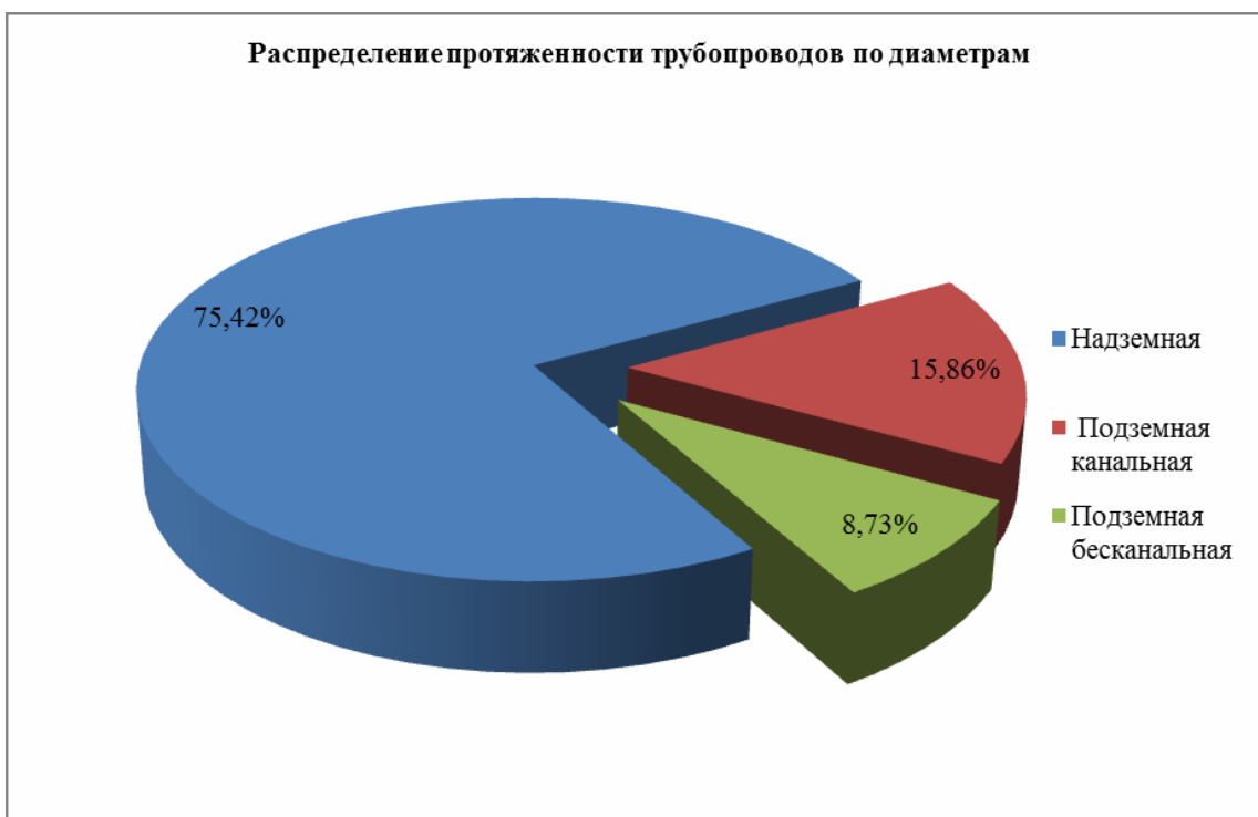
Рисунок 15 Распределение протяженности тепловых сетей по типу прокладки от центральной ОПХ
