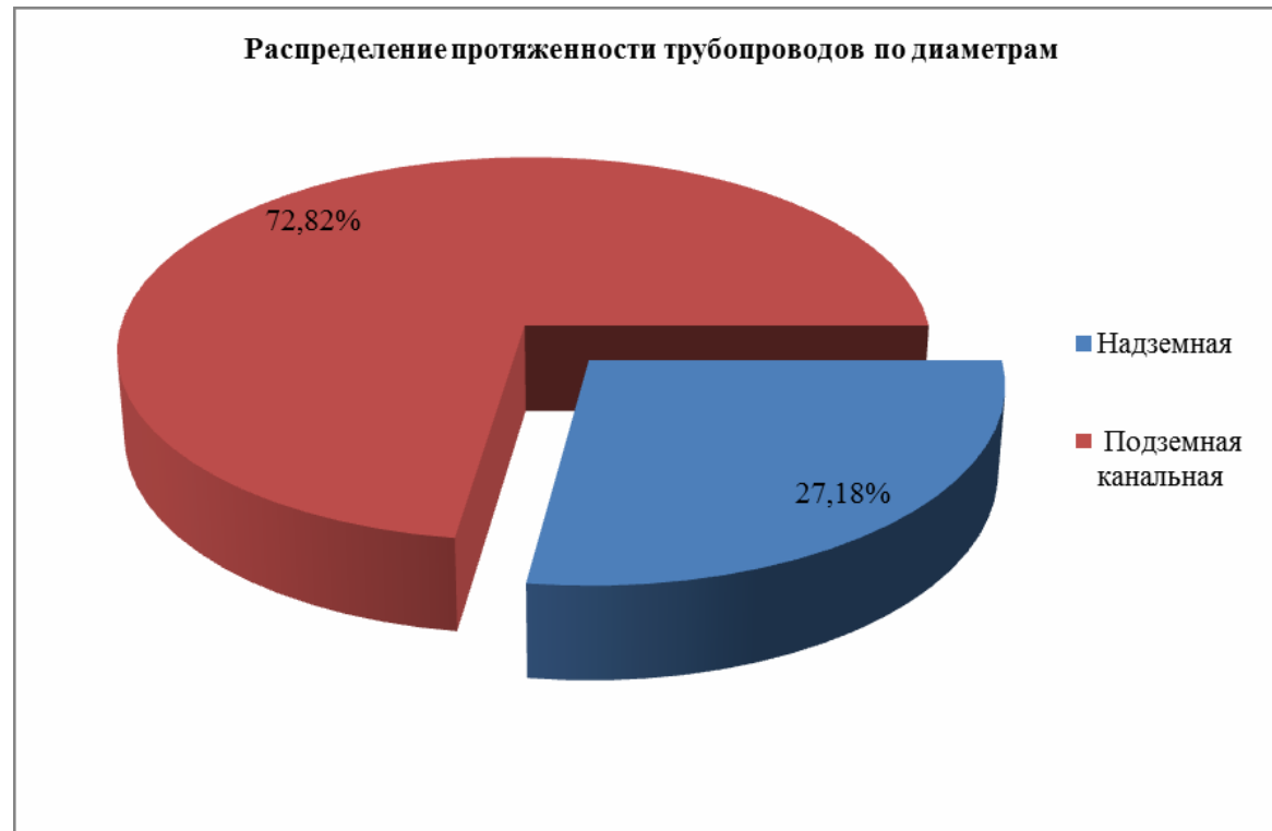
Рисунок 11 Распределение протяженности тепловых сетей по типу прокладки от центральной котельной
