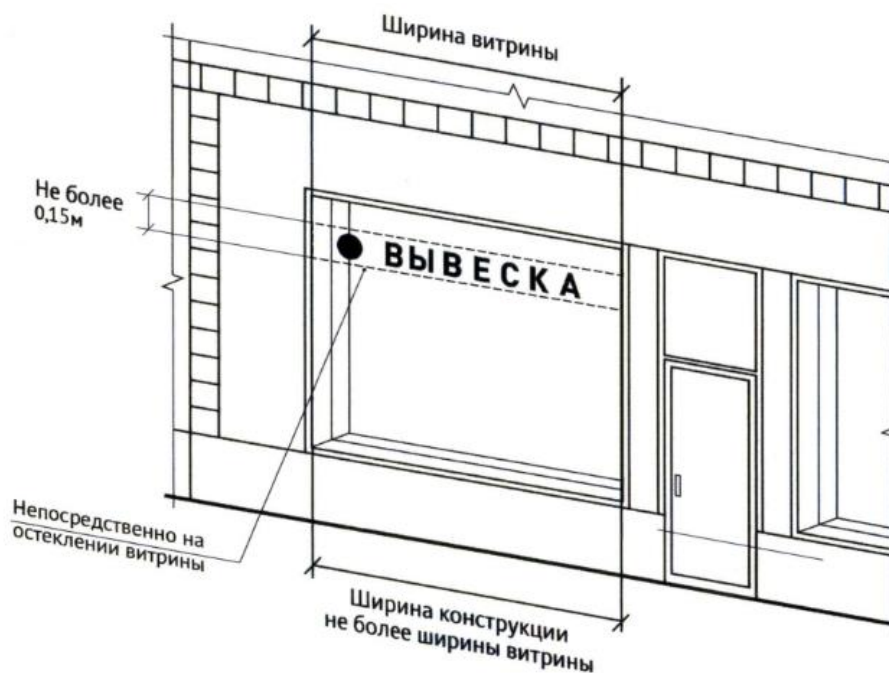
Рисунок 13 – Пример размещения витринной конструкции на остеклении.
