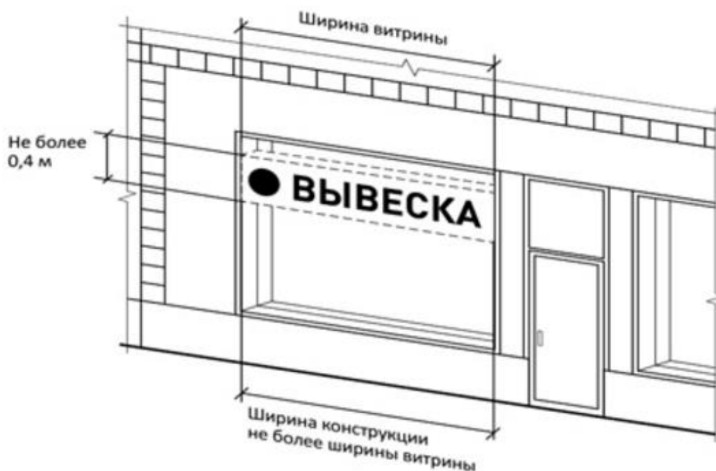
Рисунок 12 – Пример размещения витринной конструкции.
