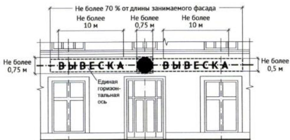
Рисунок 7 –Пример размещения составной вывески на фасаде.
