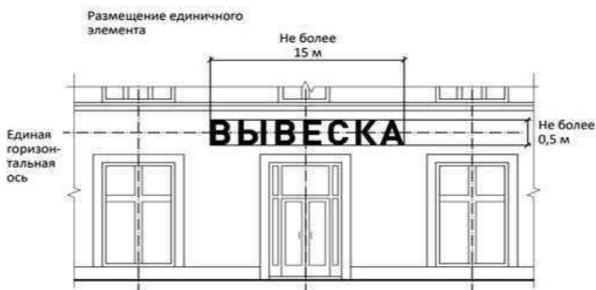
Рисунок 5 –Пример размещения вывески на фасаде.
