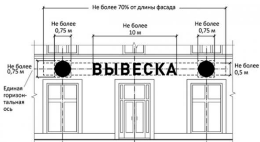
Рисунок 6 –Пример размещения вывески и декоративно-художественного элемента на фасаде.
