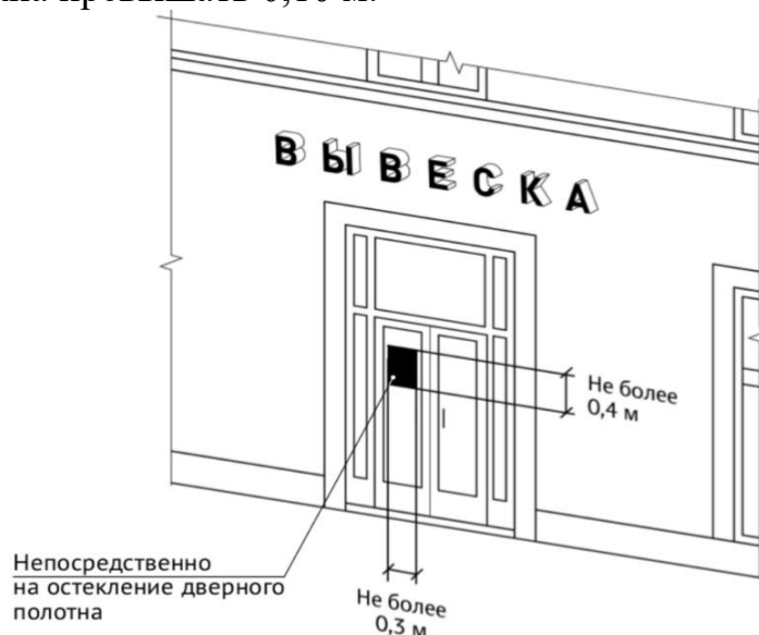
Рисунок 15 – Размещение режимной таблички на остеклении дверного полотна.
