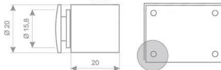
Чертеж фрагмента крепежа таблички к фасаду здания
